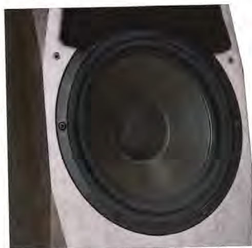
こちらも実績あるノーマックス/ケプラーコーンを採用した28センチウーファー。ウーファー下部の面取りも音の広がりを助けている。フロントバツフルは硬質MDFによる7層構造で、それぞれの板の共振を抑えるためその厚みはコントロールされている。
